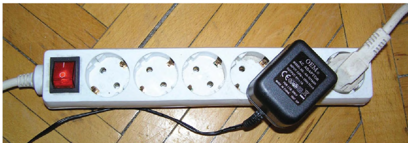
Рис. 32. Промышленный сетевой фильтр по питанию (ФП) Pilot
