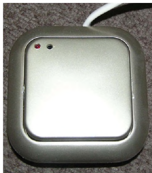
Рис. 96. Внешний вид электронного сенсорного диммера с возможностью дистанционного управления с помощью ИК-лучей (от любого пульта ДУ)
