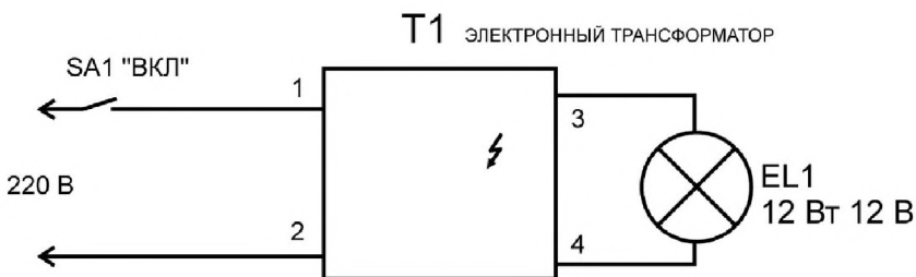
Рис. 99. Электрическая схема подключения электронного трансформатора
