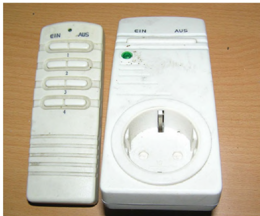
Рис. 78. Трехканальный дистанционный выключатель (по радиоканалу)
