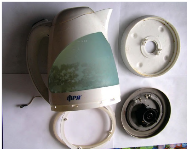
Рис. 107. Части электрочайника Energy модели E-203
