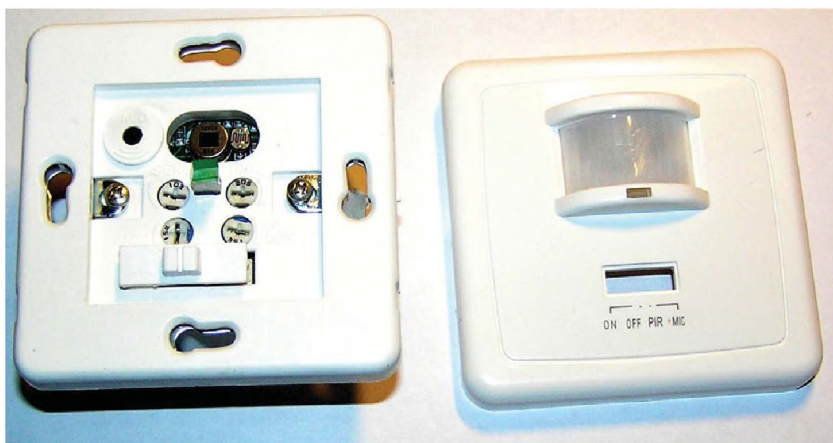
Рис. 53. Вид со снятой передней панелью – для доступа к элементам настройки
